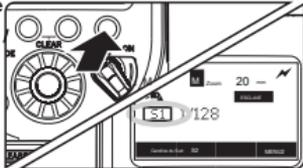
?? S'il vous plaît permettre à la face du capteur de déclenchement sans fil au flash maître en tournant la tête du flash. Avant la prise de vue, l'unité esclave et l'unité maître doit être mis sur le même canal.
